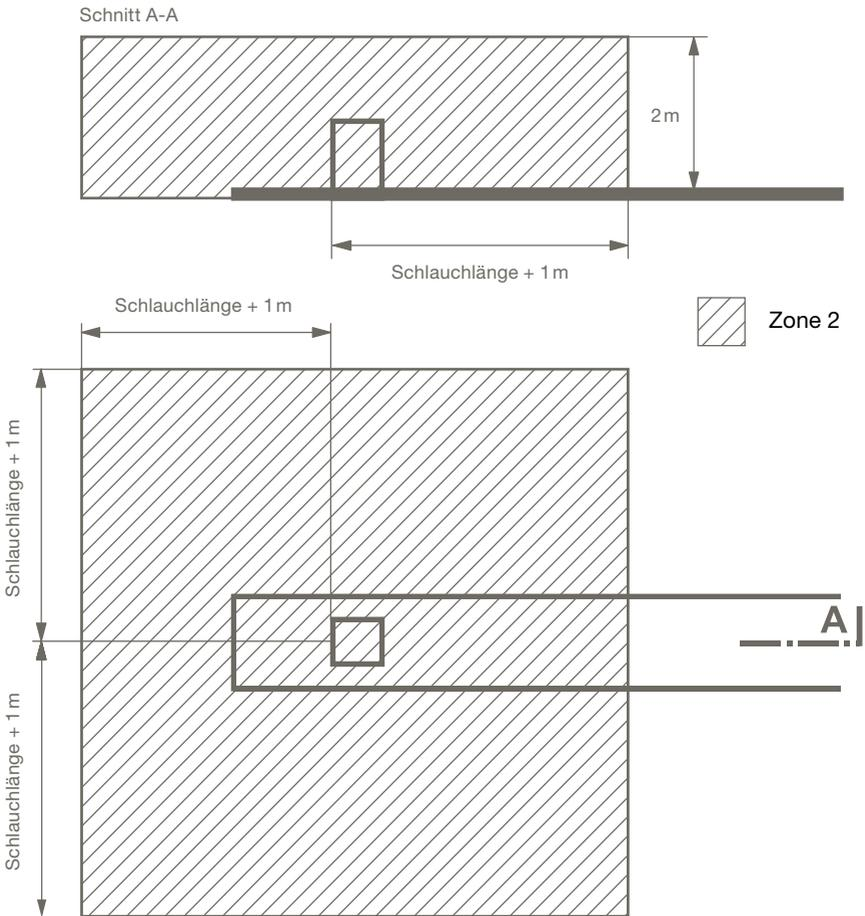
Massgebend ist die mögliche Betankungsposition bzw. der Füllstutzen des Fahrzeugs
